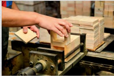
駒と呼ばれる側板を四角に組み上げた木枠に、底板を貼り付ける「底付け」工程。この後、表面の研磨、下塗り、乾燥を経て、最後に外側に上塗りをして枡の原型が完成する。写真は一合枡(180ml)
