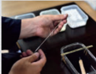
美濃和紙に火薬をのせ、ぶっくりとした穂先を造りながら持ち手に向かってこよって行く。火薬の量は0.08グラム。ほんの0.01グラムの誤差が火玉が落ちてしまうなどの原因になる
