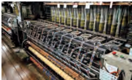
コスバ・タイバ重視とは裏腹に、チロルリボンはゆっくり緻密に織り上げていくのが特徴。写真は50年以上の歴史を経て一度動きを止めた後、松川レピヤンが受け継ぎ再稼働したシャトル織機。チロルリボンは1日かけて4mほどが織り上げられる
