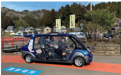
車両にAIカメラや3D-LiDAR、遠隔監視操作の通信アンテナ等を装備
